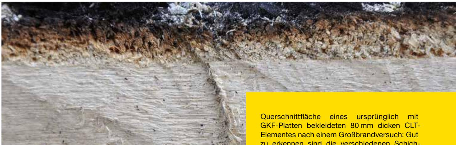
Daraus resultiert die schützende Wirkung der Kohleschicht auf noch nicht vom Brand beanspruchte, innere CLT-Lagen, sodass – anders als bei Stahl- oder Betonkonstruktionen – die massive Holzkonstruktion bei einem Brand zwar verkohlt, aber der Pyrolysevorgang und das Verhalten von Holz unter Brandeinwirkung berechenbar und vorhersehbar sind.
